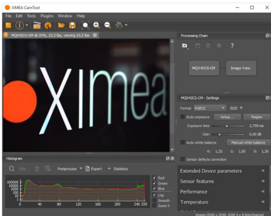
CamTool は処理チェーン機能 (画像の右上) をサポートしており、ユーザーはカメラからビューまでのプロセスのパイプラインを確認し、それを複数のビューに分割できます。
